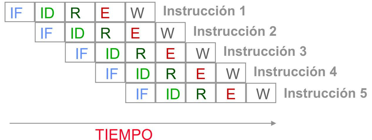
Funcionamiento de un procesador segmentado
